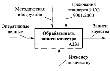
Рис. 20. Функциональный блок процесса «Обрабатывать записи качества»
