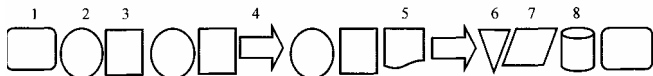
Рис. 15. Диаграмма потока процессов: 1 - начало (конец), 2 - технологические операции, 3 - контроль, 4 - транспортировка в другой цех, 5 - документ на готовое изделие, 6 - хранение, 7 - электронная копия документа, 8 - банк данных [16]
