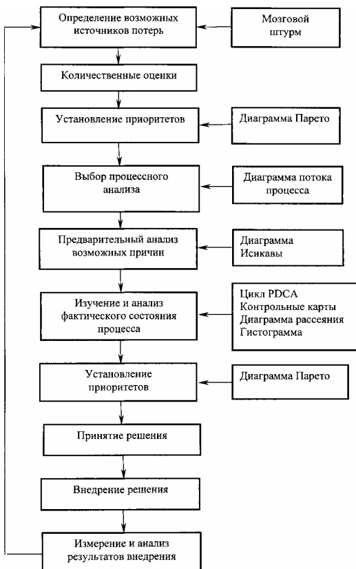
Рис. 10 Блок-схема принятия решения
